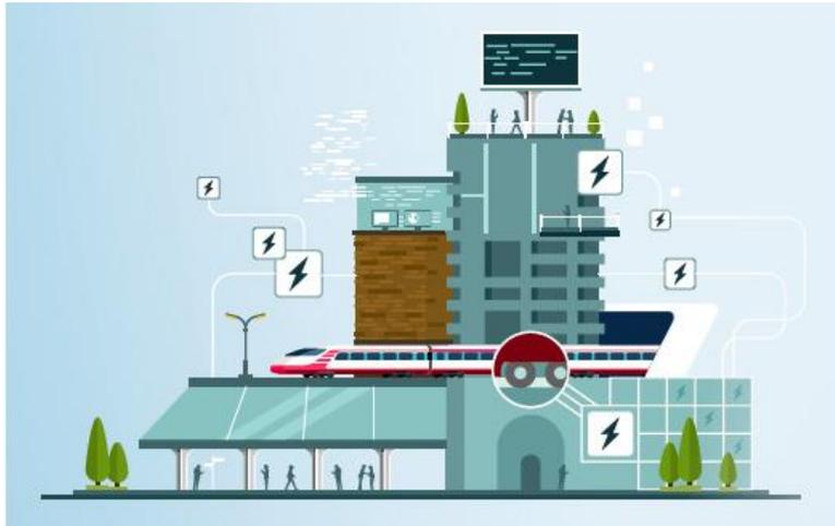
« AixPloratoire » gare d'Aix-en-Provence TGV où un premier microgrid expérimental vient de voir le jour dans le cadre d'un ambitieux programme d'innovation, avec une ombrière photovoltaïque qui alimente quatre bornes de recharge de véhicules électriques, couplée à une batterie Li-ion utilisée pour offrir de la flexibilité dans la gestion des flux d'énergie.
