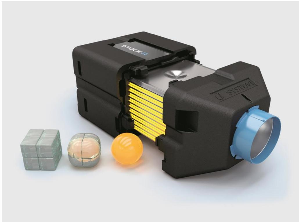
Le MCP utilisé a une chaleur latente de fusion de 200 KJ/kg à 30°C. La batterie de 40 kg permet de restituer 2,4 kWh , soit 5 h d'air chaud à 27°C à un débit de 200 m<sup>3</sup>/h
