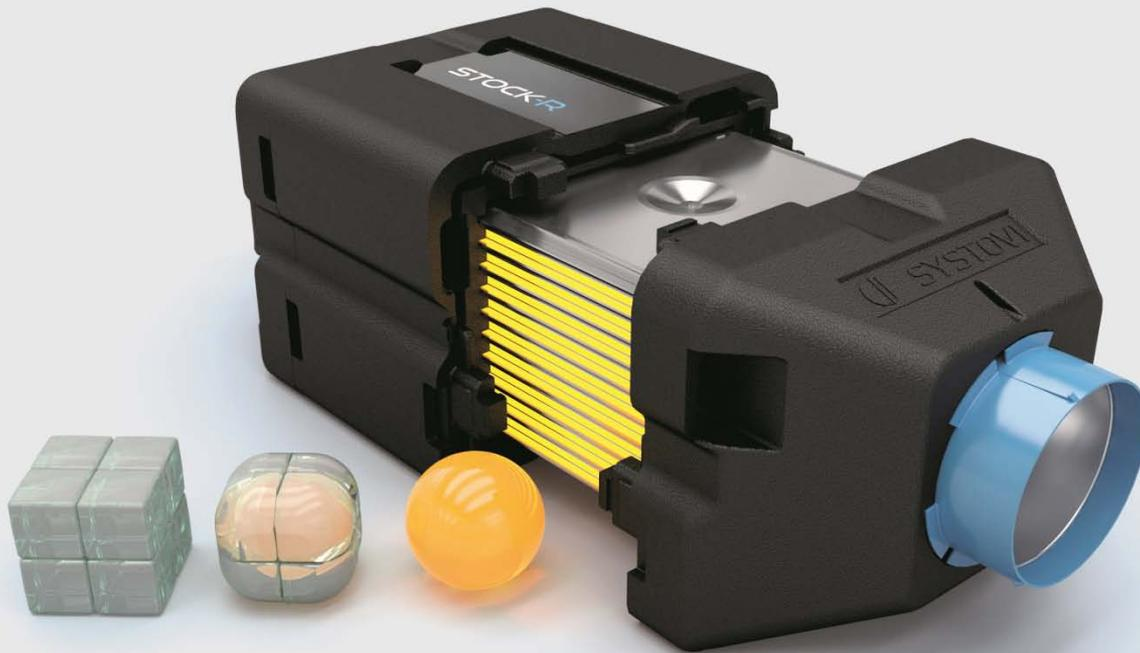
Le MCP utilisé a une chaleur latente de fusion de 200 KJ/kg à 30°C. La batterie de 40 kg permet de restituer 2,4 kWh , soit 5 h d'air chaud à 27°C à un débit de 200 m<sup>3</sup>/h
